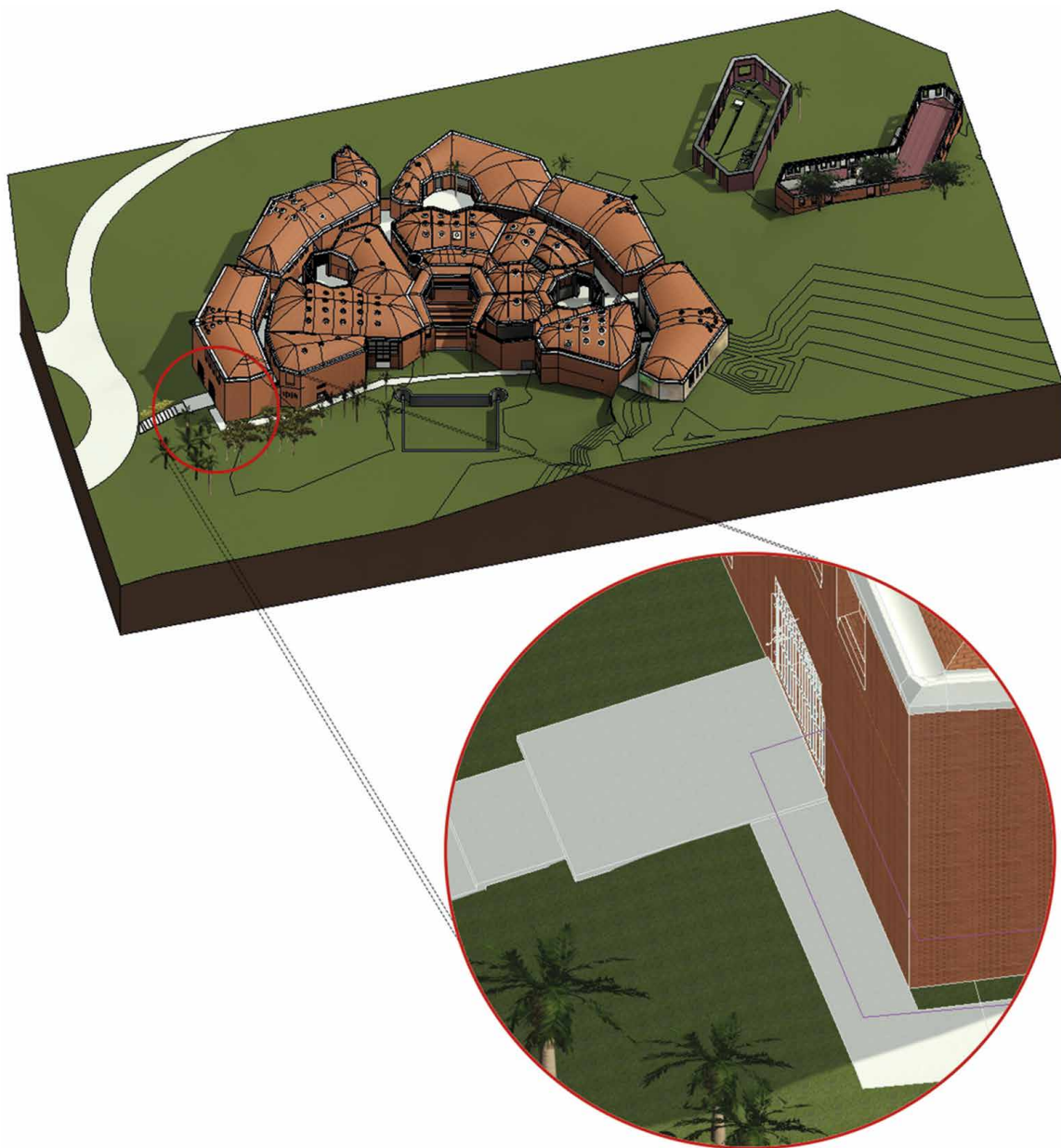
Fig. 18 | Creación de subregiones dentro de la superficie topográfica. | Creazione di sottoregioni interne alla superficie topografica.
