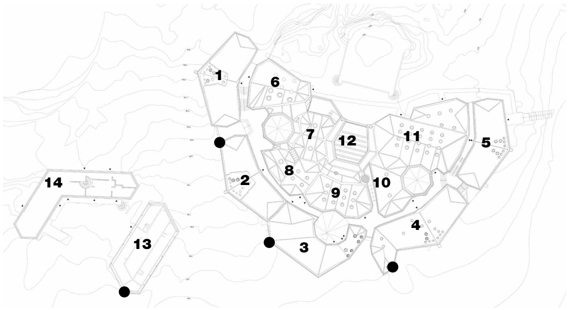
Fig. 21 | Esquema planimétrico con los puntos donde se realizaron las pruebas de cimentación. | Schema planimetrico con i punti in cui sono stati realizzati i saggi di fondazione.
