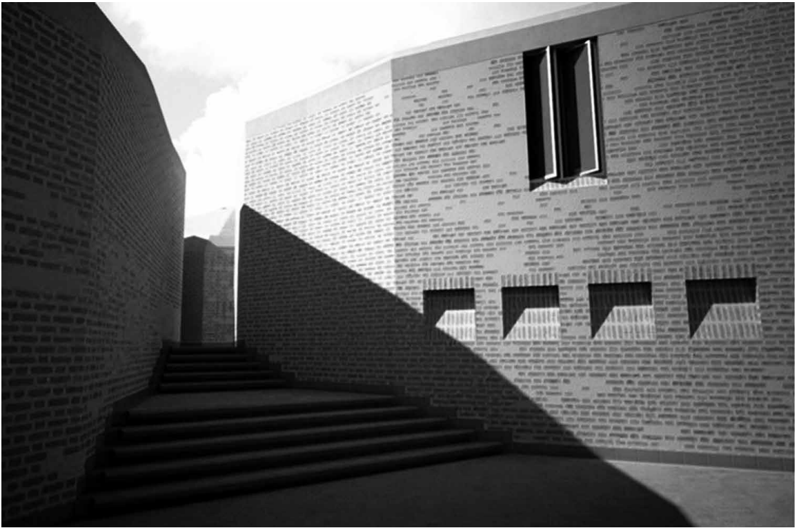
Fig. 44 | Vista de una salida hacia el área verde, propuesta de restauración de los muros, marcando las huellas del paso del tiempo mediante la aplicación de cemento de relleno, modelo virtual 2008, creado por Carlos Rodríguez Estévez (cortesía de Roberto Gottardi). | Vista di un'uscita verso l'area verde la proposta di ripristino delle murature, marcando i segni lasciati dal trascorrere del tempo applicando del cemento riempitivo, modello virtuale 2008, realizzato da Carlos Rodríguez Estévez (cortesía di Roberto Gottardi).
