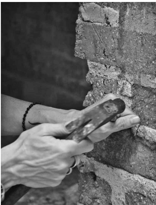
Fig. 3 | Muestras de ladrillos sometidas a análisis en el CNR de Florencia para deducir la caracterización físico-química del material (créditos: Stefania Aimar). | Campioni di laterizio sottoposti ad analisi presso il CNR di Firenze per desumere la caratterizzazione fisico-chimica del materiale (credits: Stefania Aimar).
