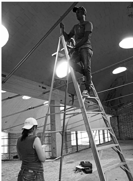
Fig. 29 | Bloque 11, ensayos en los tensores (créditos: Sara Garuglieri). | Blocco 11, prove sui tiranti (credits: Sara Garuglieri).
