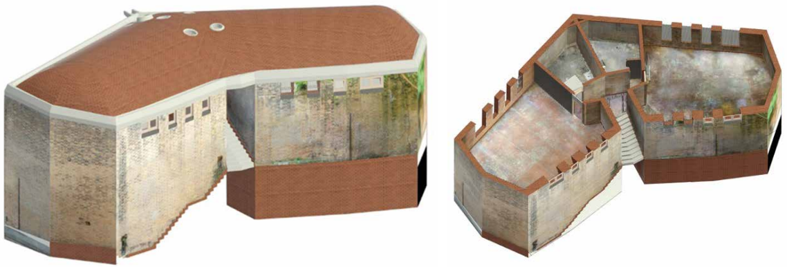
Fig. 49 | Vista 3D de los muros exteriores del bloque 1 con inserción de los fotoplanos correspondientes y sección horizontal 3D con inserción de los fotoplanos de pavimentos y muros interiores. | Vista 3D delle pareti esterno del blocco 1 con inserimento dei relativi fotopiani e sezione orizzontale 3D con inserimento dei fotopiani relativi a pavimenti a pareti interne.
