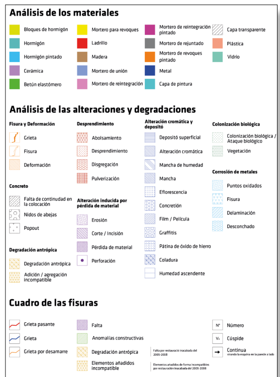
Fig. 5 | Leyenda relativa al análisis de los fenómenos de degradación e inestabilidad. | Legenda relativa all'analisi dei fenomeni di degrado e di dissesto.
