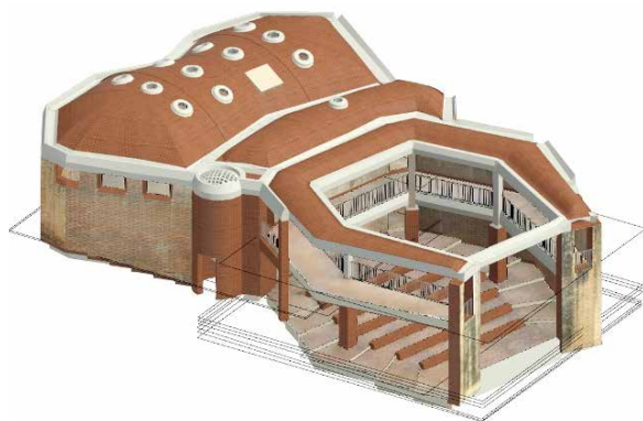
Fig. 55 | Vista 3D de los muros exteriores de los bloques 9 y 12 con inserción de los fotoplanos correspondientes y sección horizontal 3D con inserción de los fotoplanos de pavimentos y muros interiores. | Vista 3D delle pareti esterno dei blocchi 9 e 12 con inserimento dei relativi fotopiani e sezione orizzontale 3D con inserimento dei fotopiani relativi a pavimenti a pareti interne.
