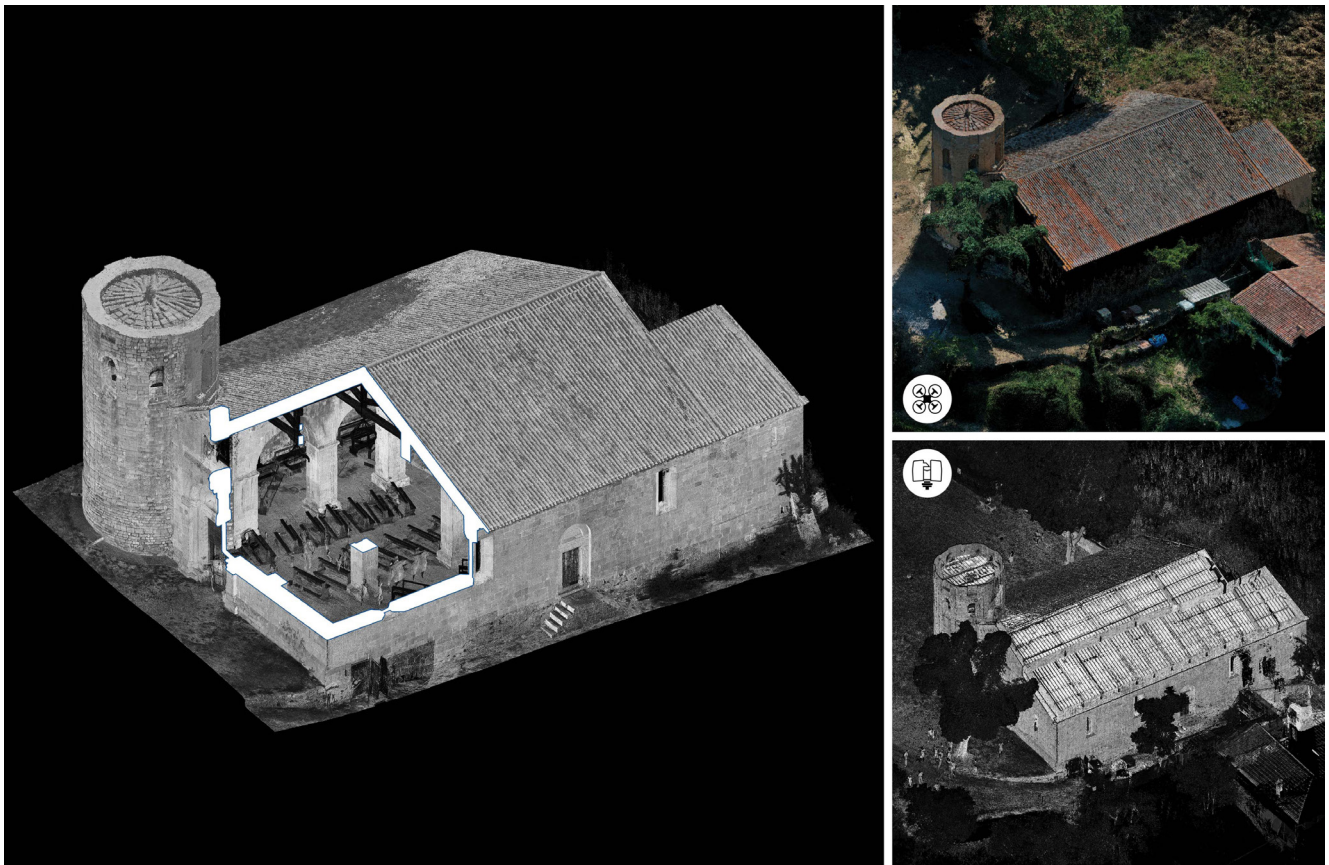
Fig. 2: Risultati delle acquisizioni dati reality-based; da sinistra in senso orario: nuvola di punti laser scanner e fotogrammetrica integrata; modello fotogrammetrico mappato con texture; nuvola di punti laser scanner
