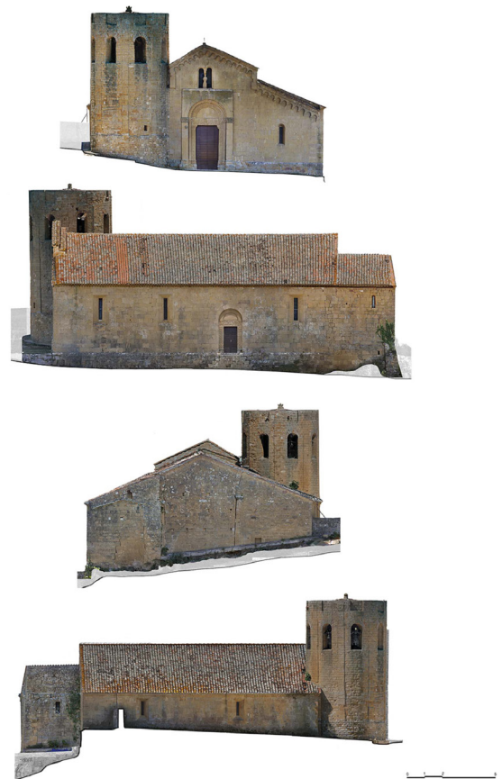
Fig. 3: Elaborati grafici bidimensionali ottenuti dal trattamento dei dati di rilievo reality-based
