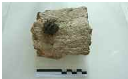
fig. 31. Frammento di tonaca di campana di grandi dimensioni con residuo di sporgenza per legare le corde utili alla separazione degli stampi.
