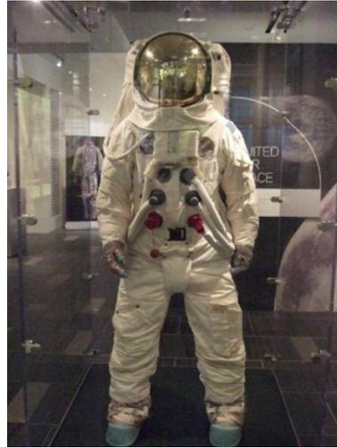
*Figura 2: Replica della tuta spaziale Apollo, realizzata in PBI, esposta alla Chemical Heritage Foundation.<sup>13</sup>*
