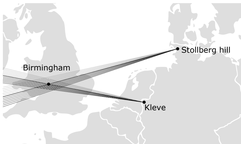
Figura 6: Sistema di guida dei bombardieri tedeschi all'inizio della Seconda Guerra Mondiale.
