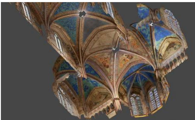
Fig. 7.4 Fasi di elaborazione del modello fotogrammetrico relativo alle volte della Basilica Superiore tramite il software Agisoft Metashape: (in alto) nuvola di punti densa; (al centro) mesh; (in basso) texture.
