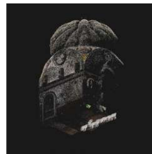
FIG. 5.7 Nuvola di punti generata da laser scanner e da rilievo SfM [elaborazione grafica di Gianmarco Domenichini].
