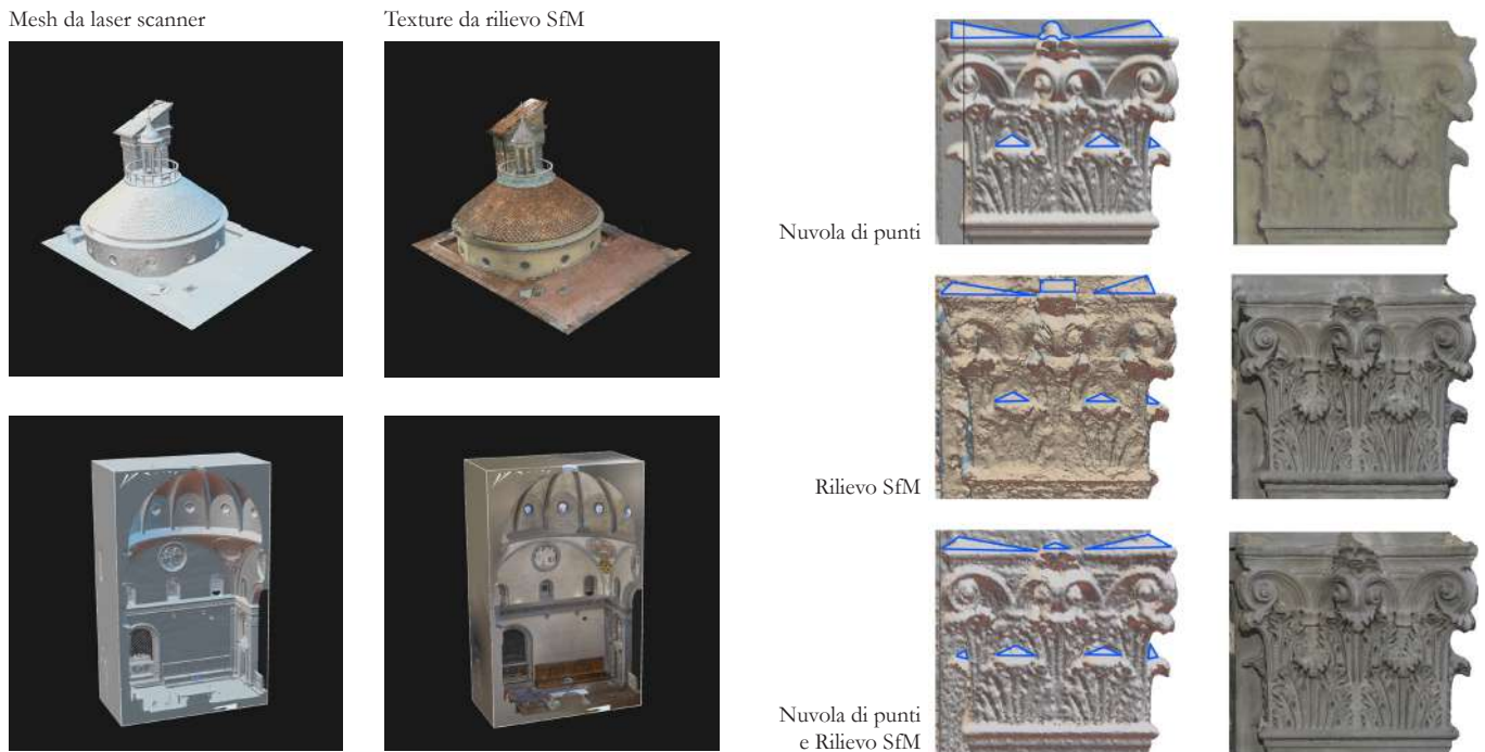
FIG. 5.8 Mesh creata dalla nuvola di punti laser scanner texturizzata con il dato fotografico derivante dal rilievo SfM. A destra la comparazione delle mesh e delle texture [elaborazioni grafiche di Gianmarco Domenichini].
