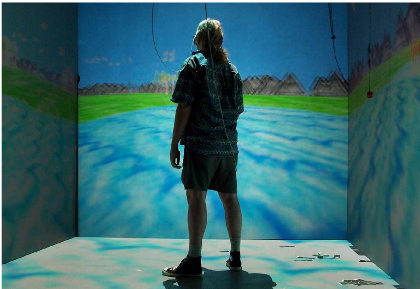
FIG. 1.26. Un'immagine di un CAVE - Cave Automatic Virtual Environment - sistema immersivo virtuale presentato al Siggraph'92 [CAVE Crayoland.jpg].
