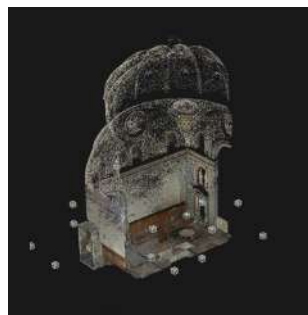
FIG. 5.7 Nuvola di punti generata da laser scanner e da rilievo SfM [elaborazione grafica di Gianmarco Domenichini].
