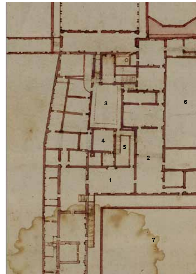
6 Bernardino Facciotto, planimetria generale del Palazzo Ducale (dettaglio rielaborato), Torino, Archivio di Stato (1: sala del Pisanello o degli Arcieri; 2: sala dei Papi; 3: cortile di Santa Croce; 4: possibile torre; 5: scalone monumentale; 6: cortile d'Onore; 7: piazza Lega Lombarda)
