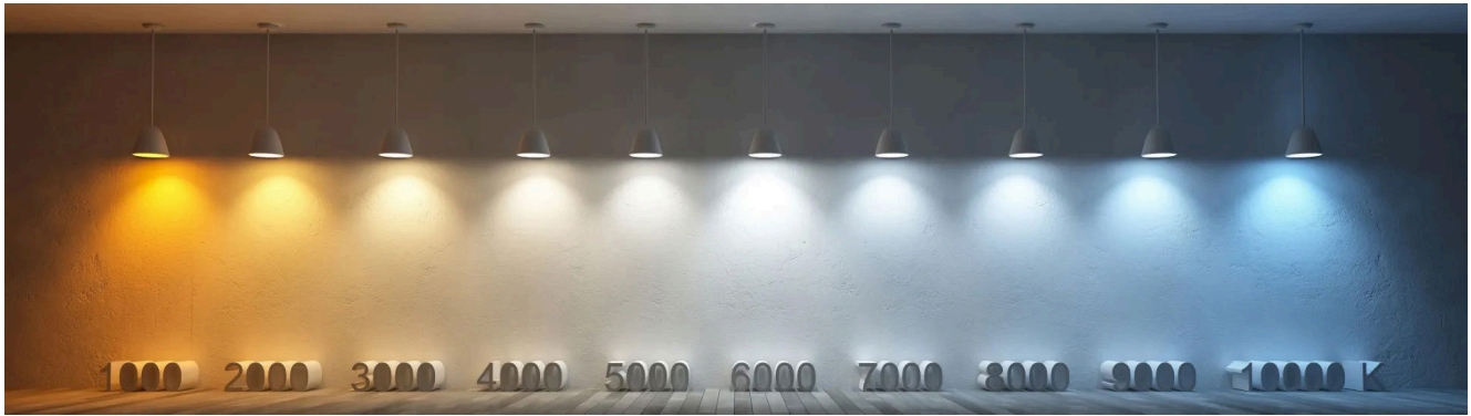
Fig. 4 Scala della temperatura di colore della luce a LED in gradi Kelvin
