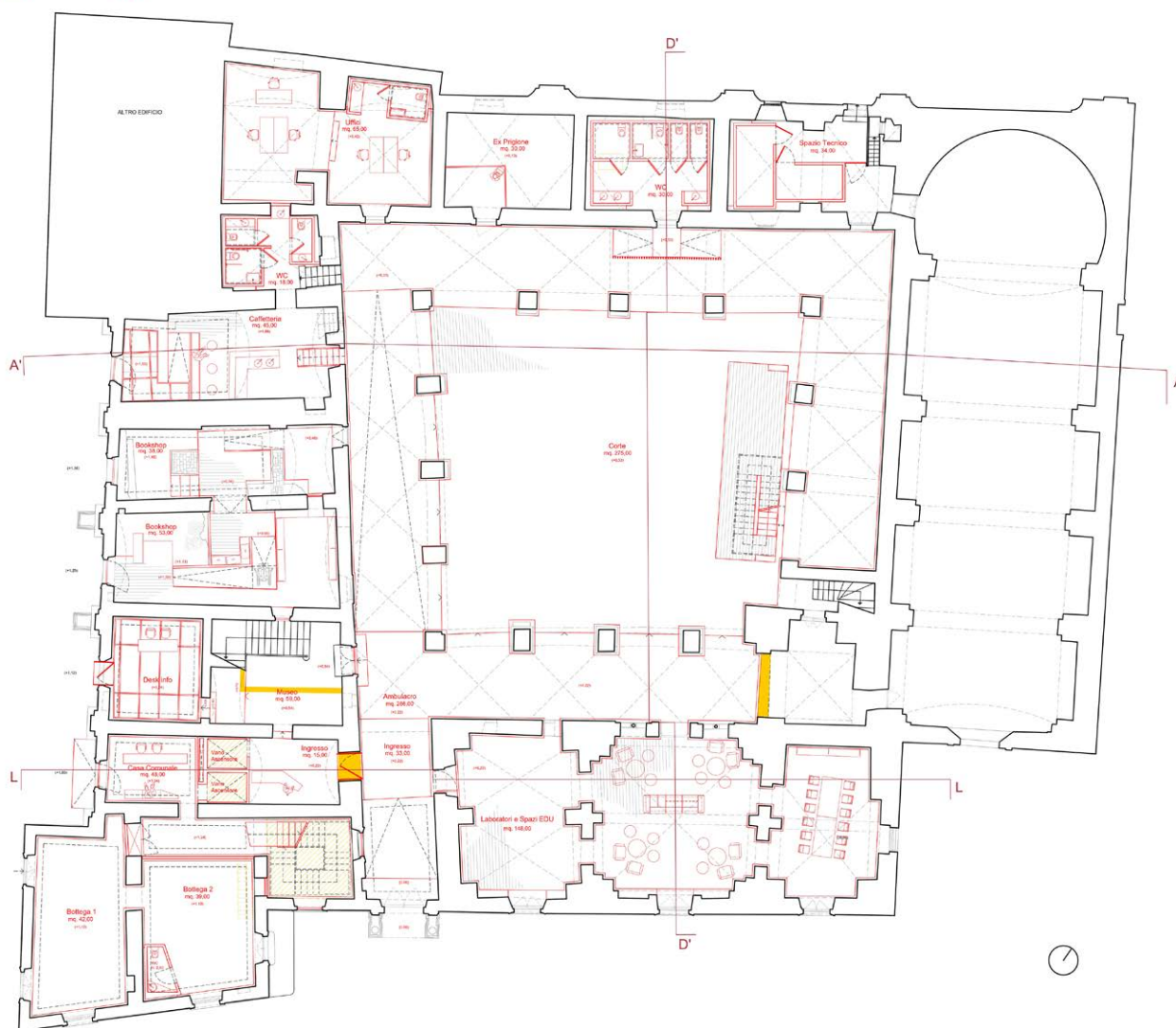
Fig. 5. Venosa (PZ), complesso di San Domenico, pianta di progetto al piano terra con indicazione delle demolizioni (giallo) e dei nuovi interventi (rosso) (elab. Convenzione DiARC 2022).
