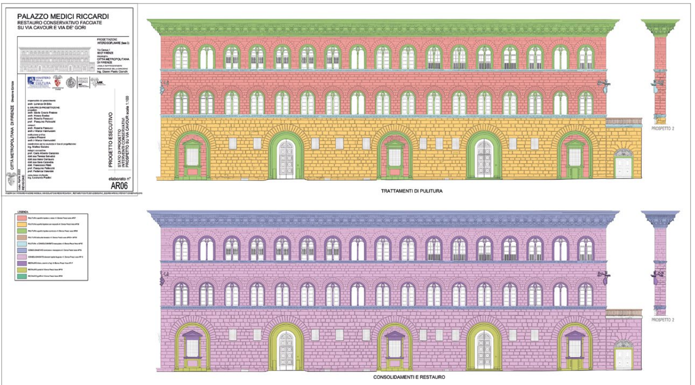
Fig. 9 – Tavola estratta dal progetto esecutivo. Rappresentazione sintetica delle tipologie degli interventi di pulitura e consolidamento.
