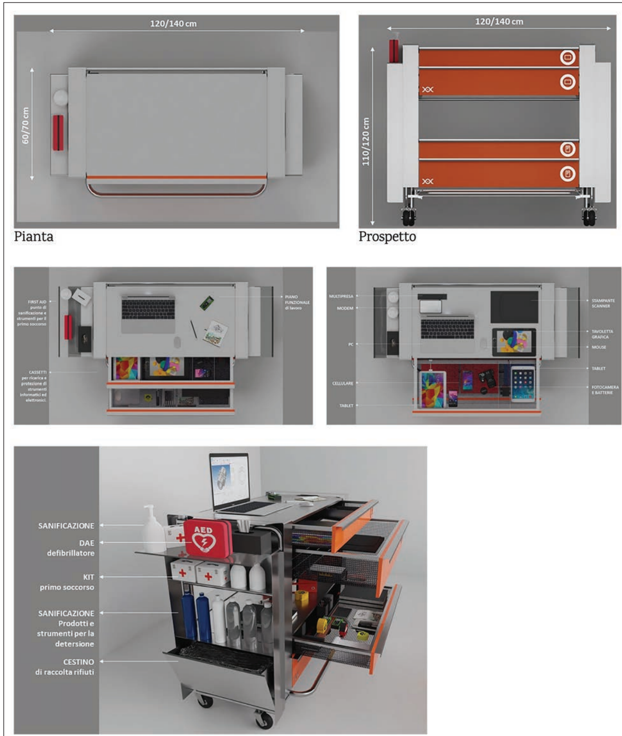
Figura 6. Progetto del desk operativo di Cantiere DOC
