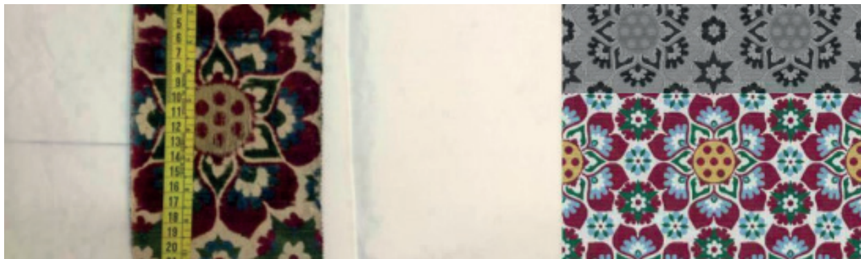
Figura 27 - Campione fisico del tessuto Medici 1400; immagine texture prodotta a CAD e mappa displacement.
