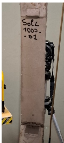
Figura Analisi e discussione dei risultati-44: Provino SolL1000_01, rottura matrice parte inferiore.
