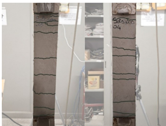
Figura Analisi e discussione dei risultati-50: Provini SolS1000_05 ed SolL3000_04, prove interrotte.
