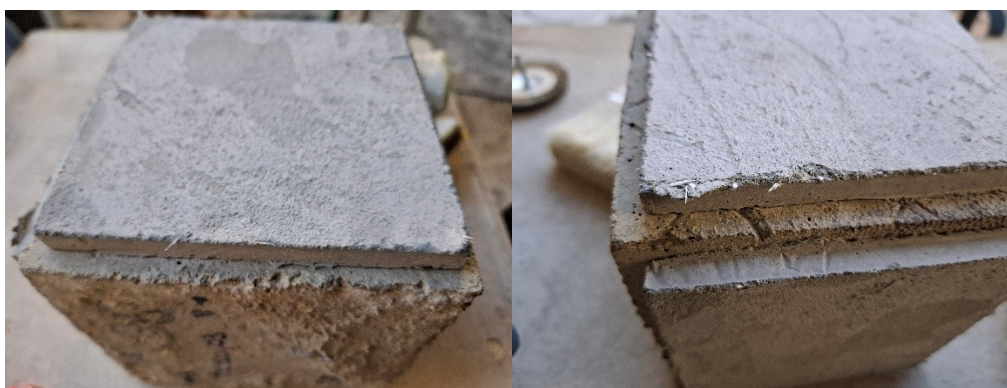
Figura Analisi e discussione dei risultati-118: Comparsa di lesioni lungo l'interfaccia composito substrato.
