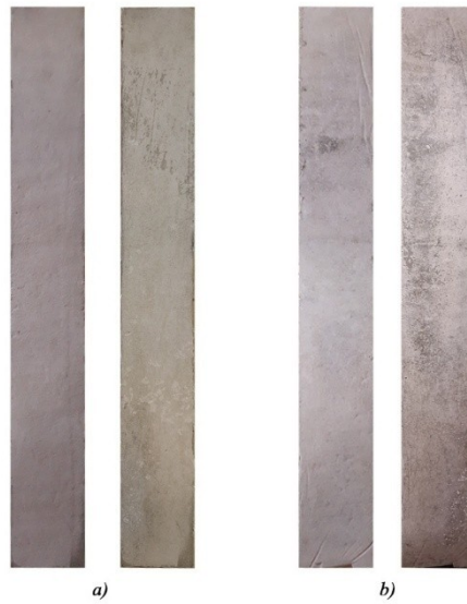
Figura Analisi e discussione dei risultati-48: a) provino prima e dopo l'invecchiamento (1000 ore), b) provino prima e dopo l'invecchiamento (3000 ore).
