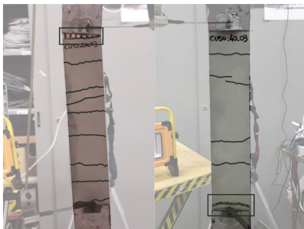
Figura Analisi e discussione dei risultati-63: Provini CU50_20_03; CU50_40_03, nei quali è ben visibile il tipo di rottura intercorso e il manifestarsi di fessure lungo tutta la lunghezza libera.
