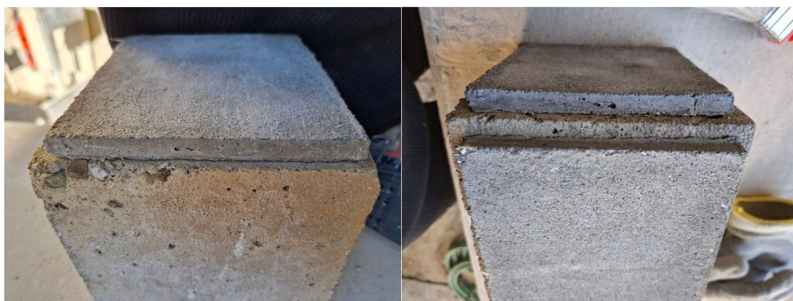
Figura Analisi e discussione dei risultati-123: Comparsa di lesioni lungo l'interfaccia composito substrato.
