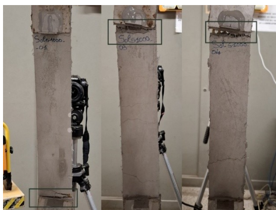
Figura Analisi e discussione dei risultati-51: Provino SolS1000_01; SolS1000_03 e SolS1000_04, rottura matrice
