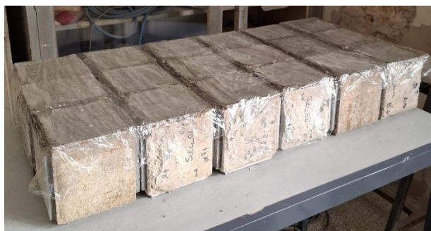
Figura Sperimentazione-19: Applicazione del composito sui cubetti.
