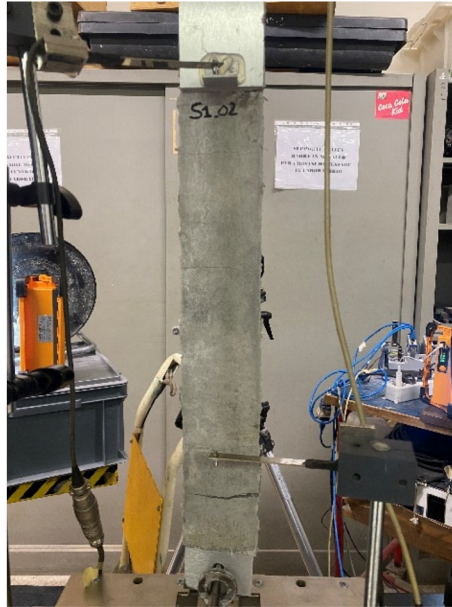
Figura Analisi e discussione dei risultati-37: Provino S1_02 dove è ben visibile il distacco della piastra inferiore.
