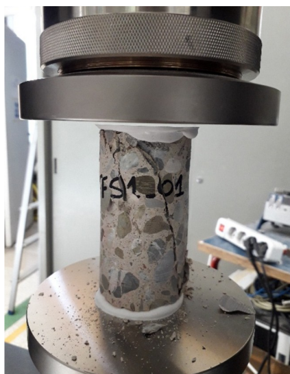
Figura Sperimentazione-30: Esempio test di compressione, provino CFS1_01.
