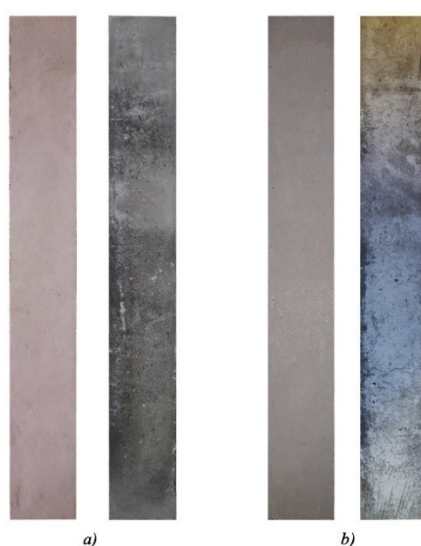
Figura Analisi e discussione dei risultati-34: a) provino prima e dopo l'invecchiamento (1000 ore), b) provino prima e dopo l'invecchiamento (3000 ore).
