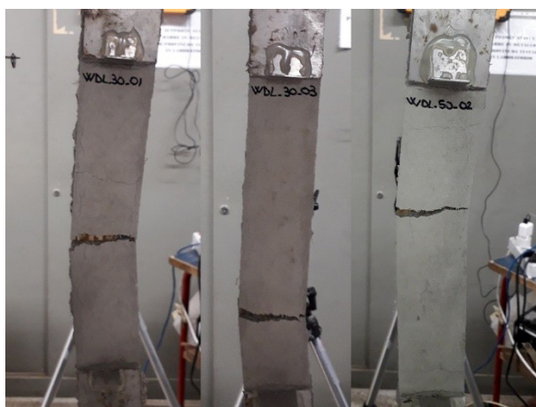
Figura Analisi e discussione dei risultati-69: Provini WDL_30_01; WDL_30_02; WDL_50_02, nei quali la rottura è avvenuta nella zona centrale della lunghezza libera.
