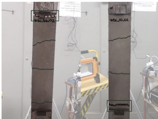
Figura Analisi e discussione dei risultati-68: Provini WDL_30_02; WDL_10_02, nei quali è ben visibile il tipo di rottura intercorso e il manifestarsi di fessure lungo tutta la lunghezza libera.
