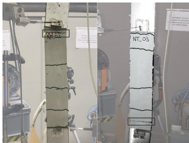
Figura Analisi e discussione dei risultati-32: Provini NT_02 ed NT_03, nei quali è ben visibile il tipo di rottura intercorso e il manifestarsi di fessure lungo tutta la lunghezza libera.
