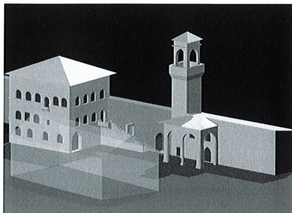
Fig. 6. La loggia della Cancelleria alla fine del XIV secolo: ricostruzione planimetrica e assonometrica (A. loggia, B. cancelleria)
