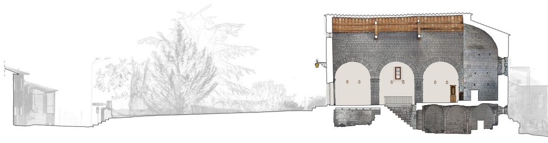
Fig. 3 – Pieve di Buiano. La sezione longitudinale della chiesa prosegue nel prato fino alla porta della originaria chiesa medievale molto più grande dell'odierna chiesetta. (Archivio Autori)
