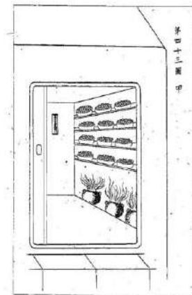
Fig. 33 – Impianto a carbone per l'uccisione delle crisalidi del 1894.
