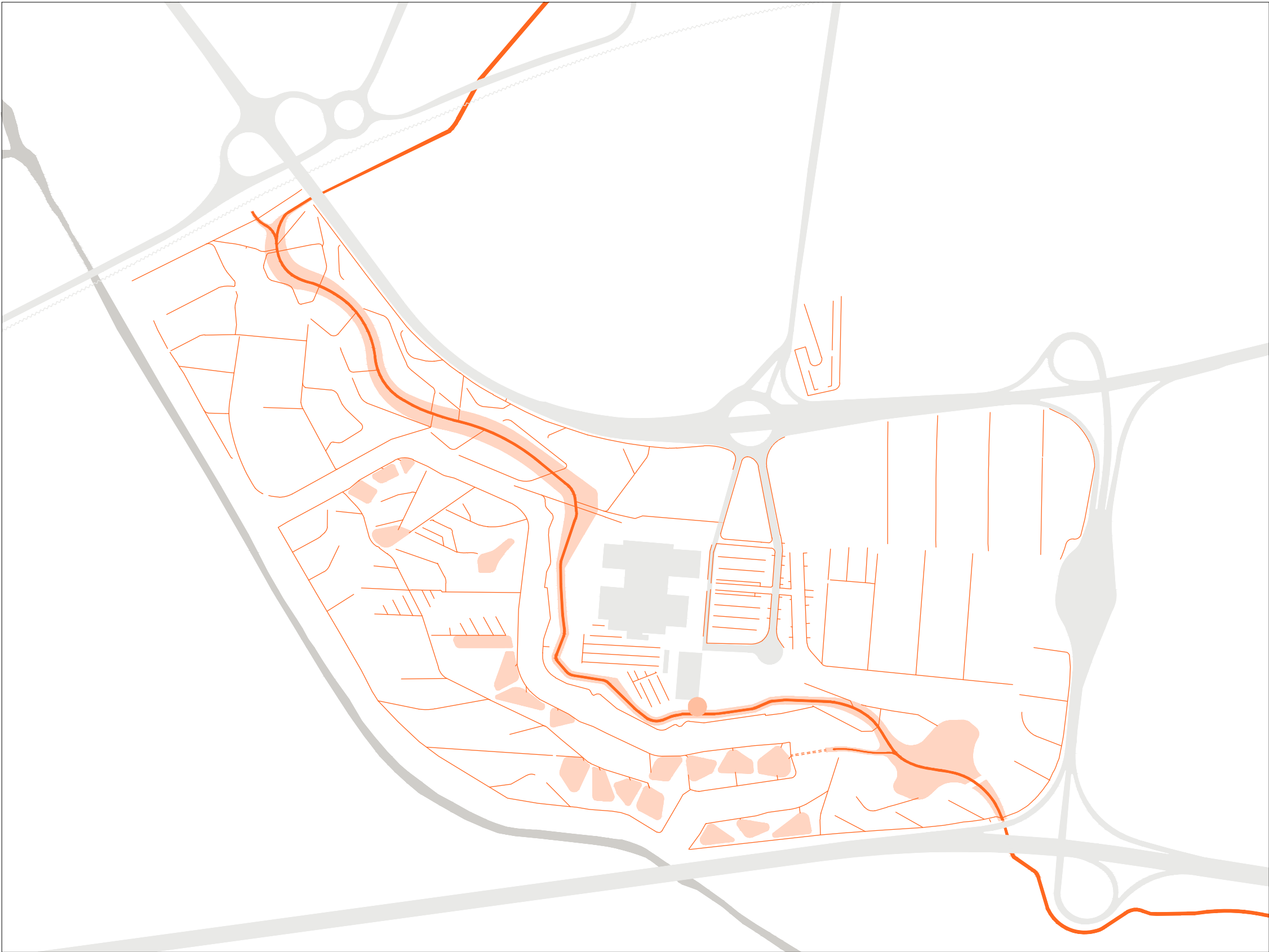
Figura 13 Rete superficiale di scolo delle acque meteoriche, laminazione del fosso Brusigliano e compensazione dei voluni/tempi di corrivazione imputati al complesso ospedaliero (il punto rosso indica lo scarico di questi ultimi nel fosso per il trattamento) (© UNIFI DIDA Landscape Design LAB, 2024)
