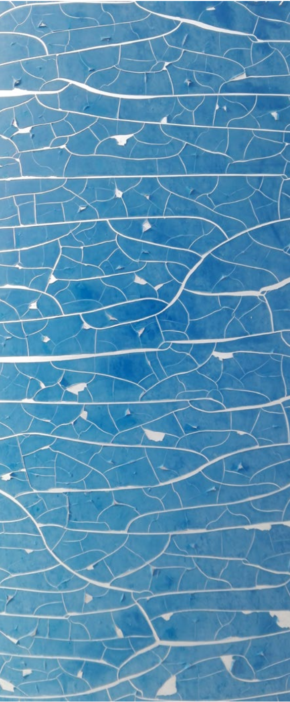
Figura 2 Forme con colori e dimensioni: crettatura e sfogliatura di smalto, esposto agli agenti atmosferici su superficie metallica inossidabile (© Gabriele Paolinelli, 2023)
