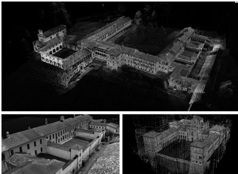
Fig.4: Digitalizzazioni dei complessi certosini realizzate con tecnologie range based e image based. (Elaborazioni degli Autori)
