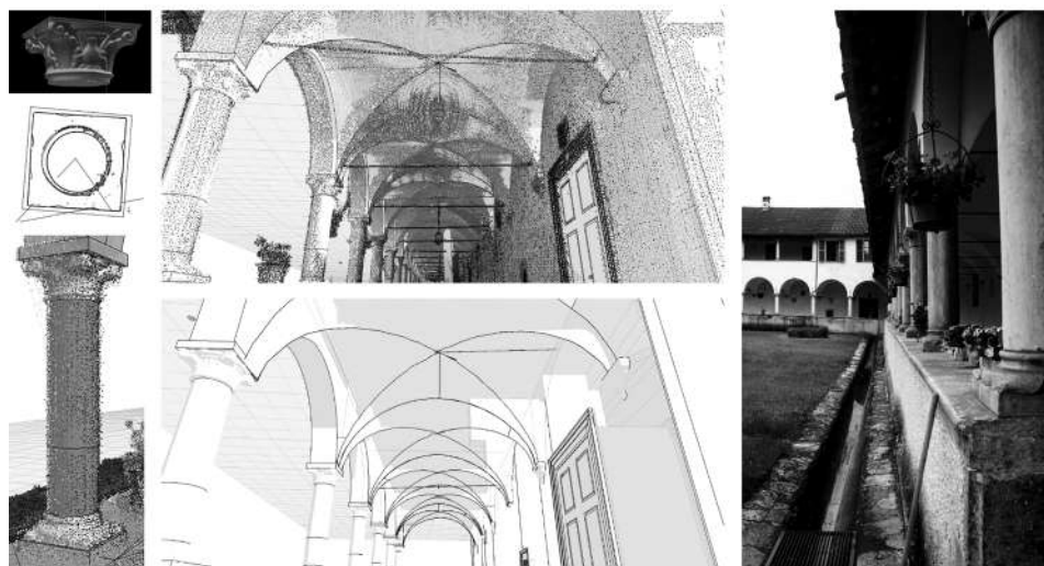
Fig.5: Processo di Modellazione Scan-to-BIM delle architetture della certosa di Pesio. (Elaborazione degli Autori)
