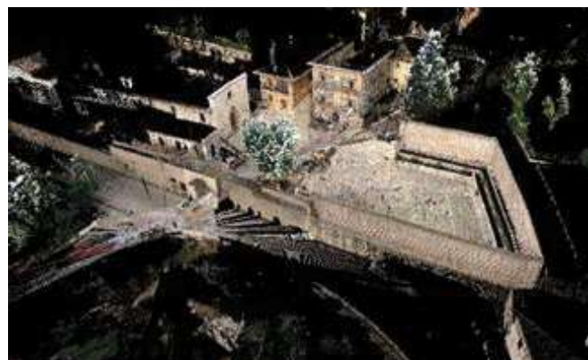
Figura 4: Nuvola di punti completa del rilievo della Fontana e della chiesa di San Vito
