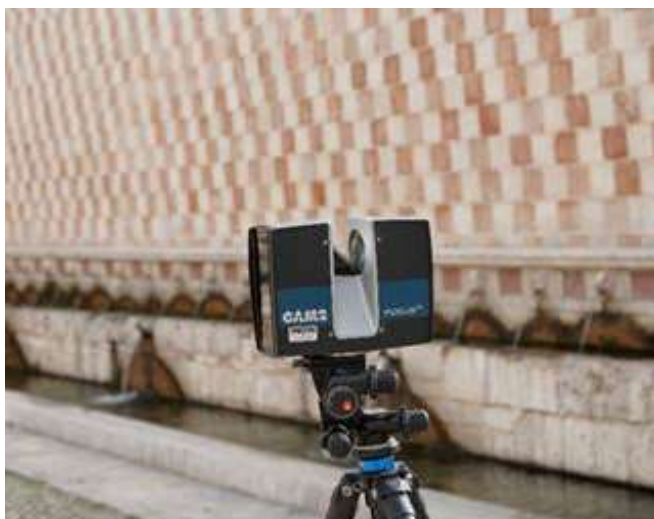
Figura 5: Il laser scanner utilizzato Faro Focus M70
