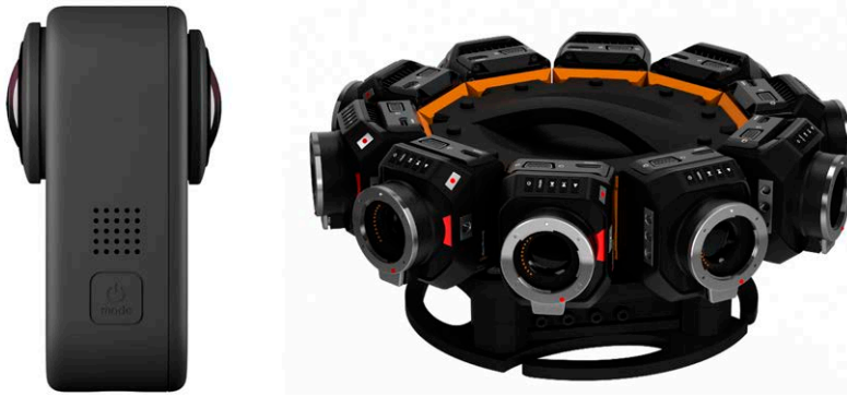
Figura 3 – Videocamera a 360° (a sinistra), RIG (a destra).
