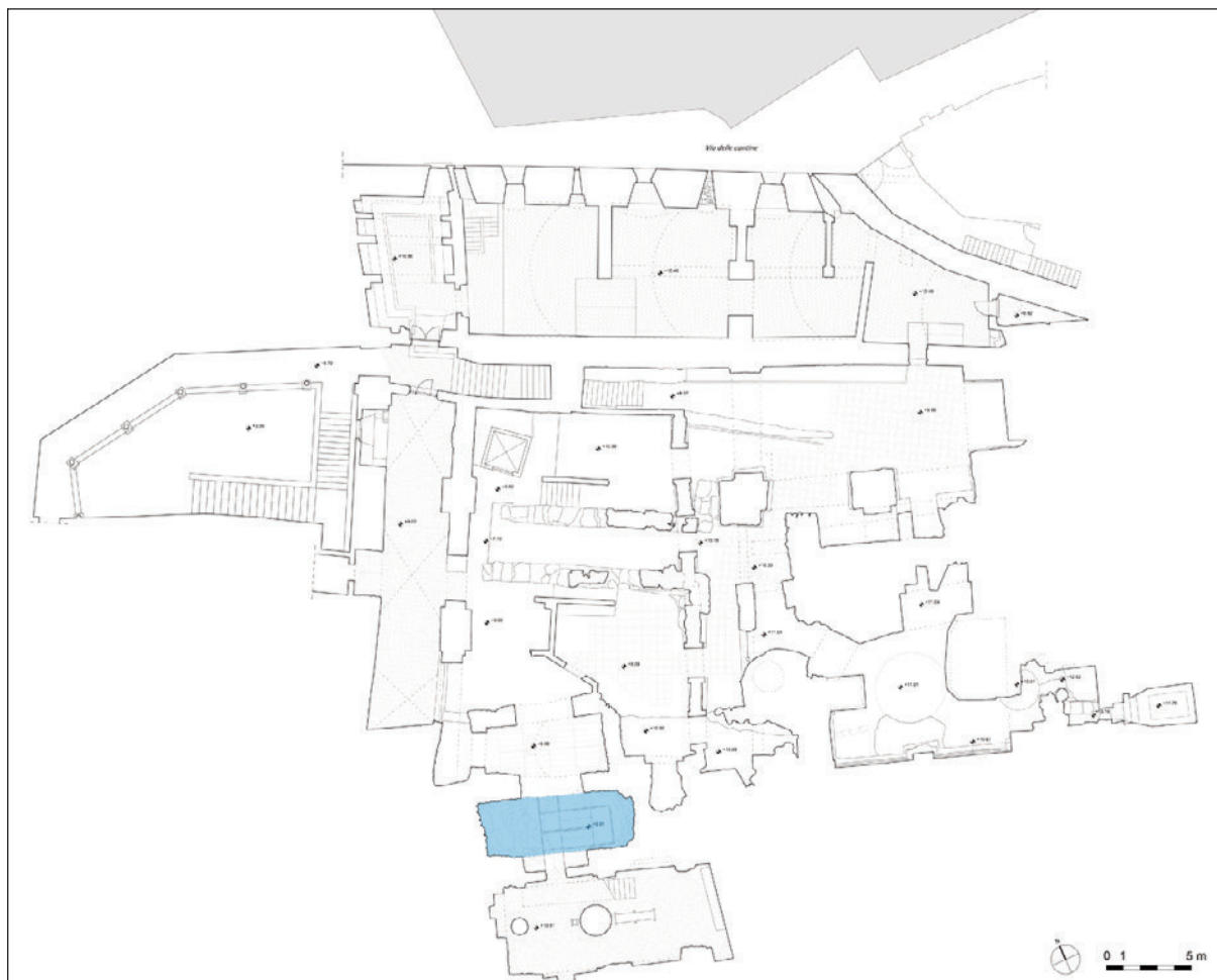
15. PIANTA DEGLI AMBIENTI IPOGEI AL LIVELLO SOTTOSTANTE IL CORTILE SUPERIORE, CON EVIDENZIATO (BLU) UN TRATTO DEL MURO SUD-OVEST DEL TERRAZZAMENTO COSTITUITO DA CONCI DI TRAVERTINO DI MEDIA-PICCOLA PEZZATURA (elaborazione Autori)
