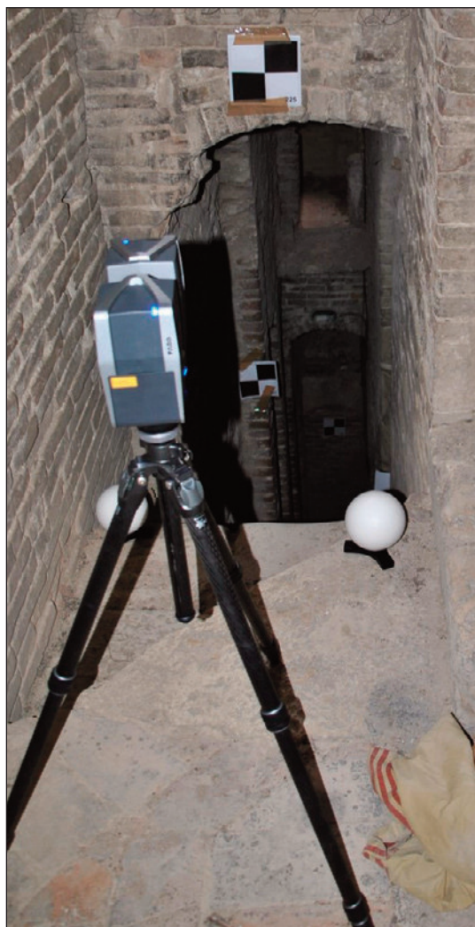
2. LASER SCANNER CON IL POSIZIONAMENTO DI TARGET E SFERE (foto Autori)
