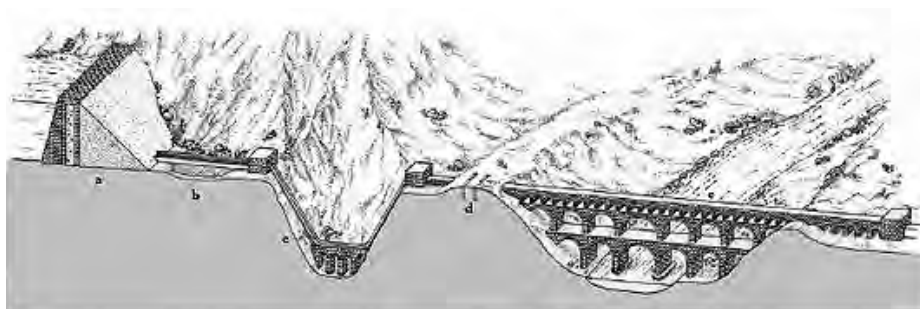
Fig. 5. Rappresentazione di un acquedotto realizzato con tratti intubati lineari, a sifone inverso e a pelo libero in galleria e in superficie. In corrispondenza di ogni variazione di tipologia si osserva la presenza di un manufatto di controllo (da: https://www.roma-noimperio.com/2017/11/idraulica-romana.html ).
