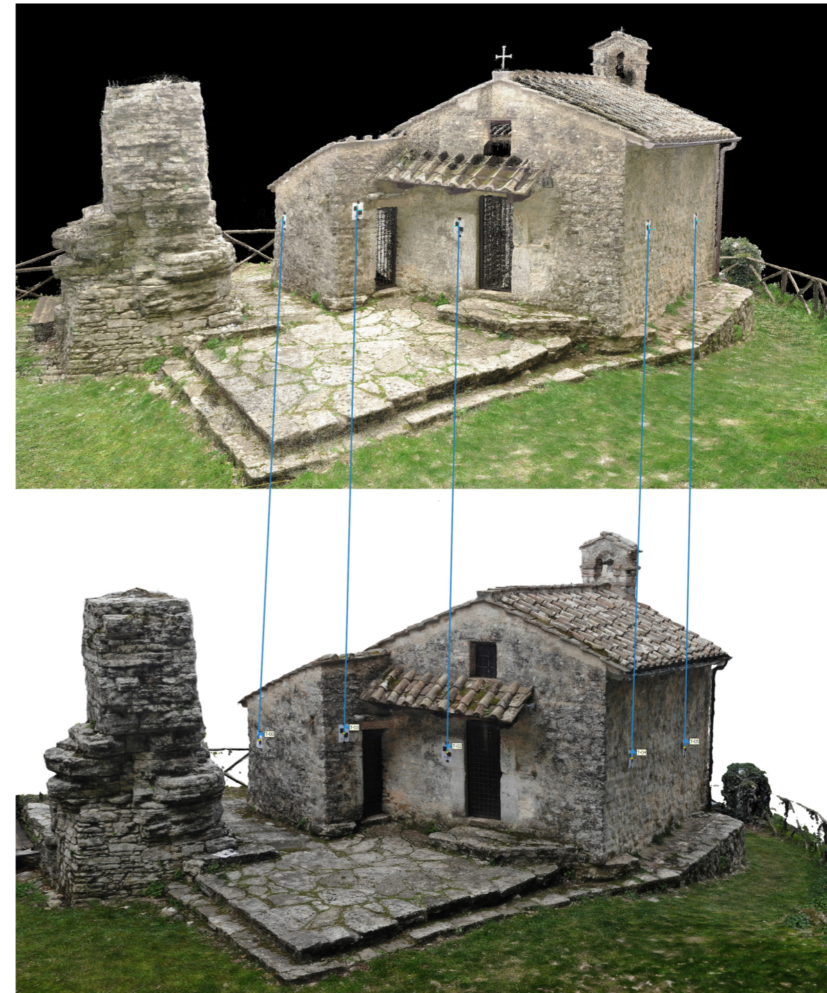
Fig. 14: Referenziazione dei modelli di mesh fotogrammetrici sulla base delle nuvole di punti da laser-scanner.
