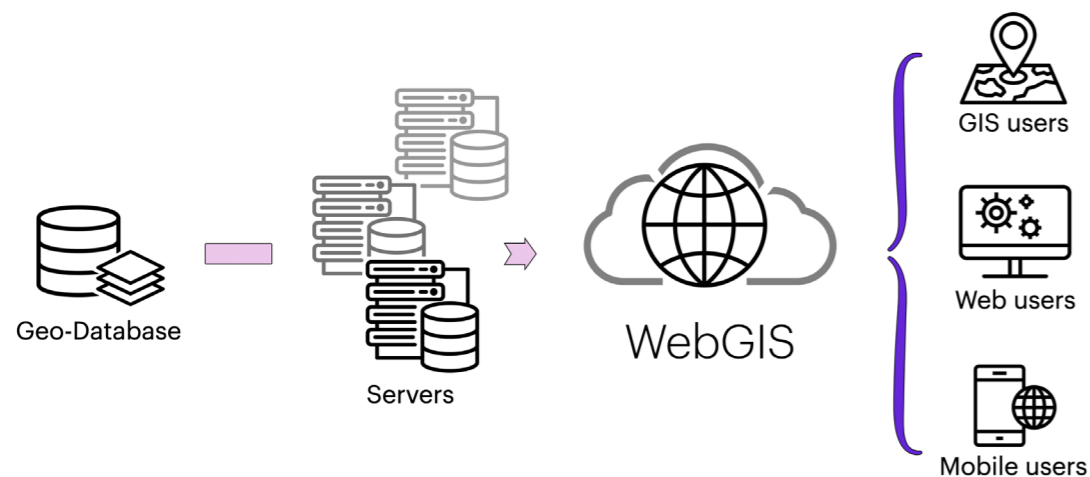
Fig. 7: Schema di funzionamento di una piattaforma WebGIS.
