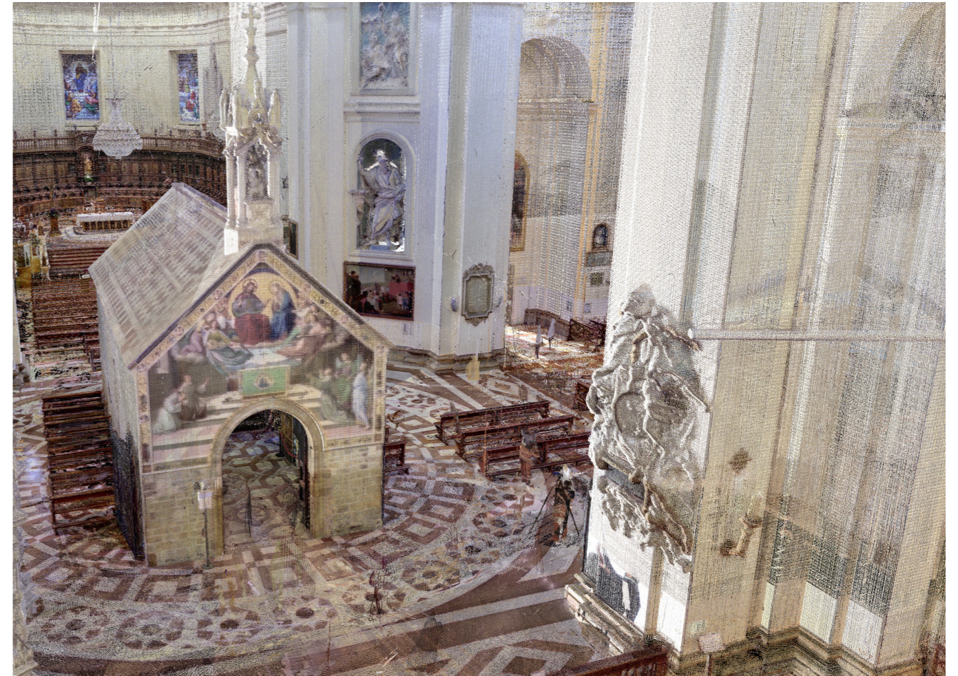
Fig. 9: Rilievo digitale laser-scanner della Porziuncola in Santa Maria degli Angeli (PG), con visualizzazione della nuvola di punti.
