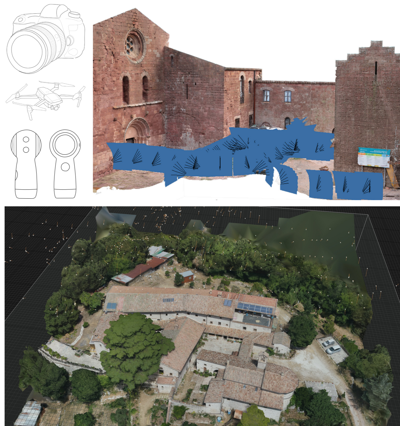
Fig. 10: Rilievo digitale fotogrammetrico con tecnica Structure from Motion da terra e aereo.
