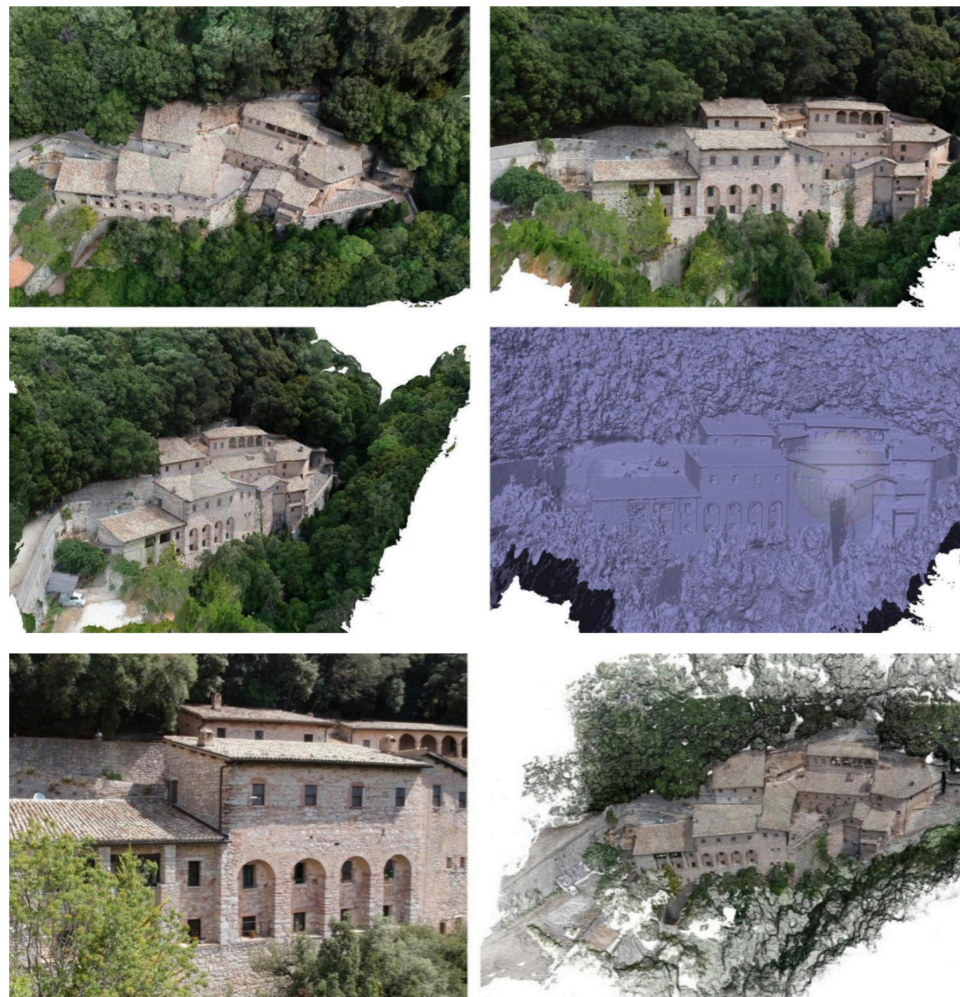
Fig. 1: Modello tridimensionale dell'Eremo delle Carceri (PG) ottenuto mediante fotogrammetria Structure from Motion da drone.
