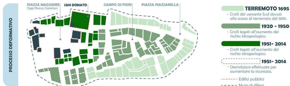
Fig. 3- Diagramma dei crolli e del processo deformativo del Borgo Fantasma di Celleno, con indicazione delle principali fasi di dissesto strutturale e idrogeologico tra il 1695 e il 2014 (Stabile, Zampilli & Cortesi, 2009)
