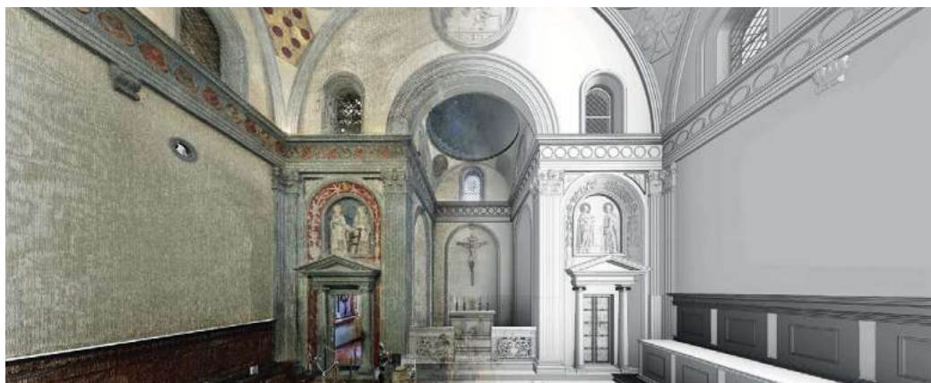
Dalla nuvola di punti al modello HBIM della Sagrestia Vecchia di San Lorenzo a Firenze.
