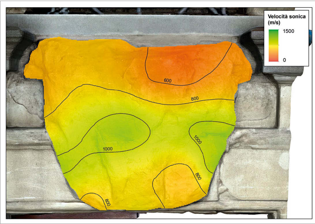
Fig. 7 – Mappa in falsi colori dello stemma di palazzo Zuccari rappresentativa dei gradienti di velocità presenti nell’oggetto (elaborazione: Dipartimento di Scienze della Terra dell’Università di Firenze).
