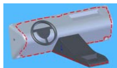
Fig. 6.5 Rimozione mediante taglio del rivestimento intorno ai punti di vincolo
