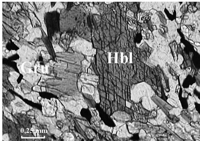
Fig. 2 - e) Green hornblende (Hbl) surrounded by a metamorphic colourless grunerite (Gru), single polars, amphibolite intercalation in micaschist, well Lumiera 1b, 3110 m, Larderello field. - e) Orneblenda verde (Hbl) circondata da anfiboli incolori termometamorfici (grunerite = Gru), nicols paralleli, intercalazione anfibolitica nei micascisti, Pozzo Lumiera 1b, m 3110, Campo di Larderello.
