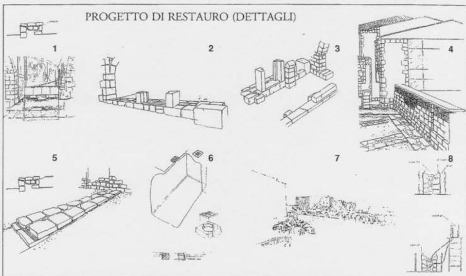
**Intervento n. 1** - a) Pulizia della cresta del muro, mediante spatola e bruschinatura; - b) Consolidamento ed eventuale fissaggio degli elementi lapidei mossi e riempimento con malta specifica additivata con antiritiro ed inerti della stessa pietra del muro; c) Posizionamento di un pannello illustrativo degli ambienti in vista, con funzionamento anche di accompagnamento al percorso.
