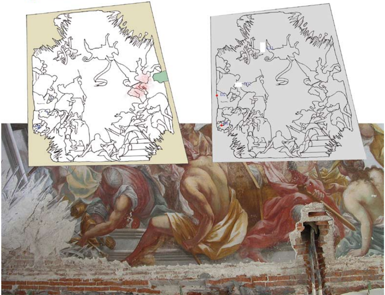
Sala di Apollo. Mappe di rilievo con segnalazione dei prelievi diagnostici e tipologia del degrado osservato
