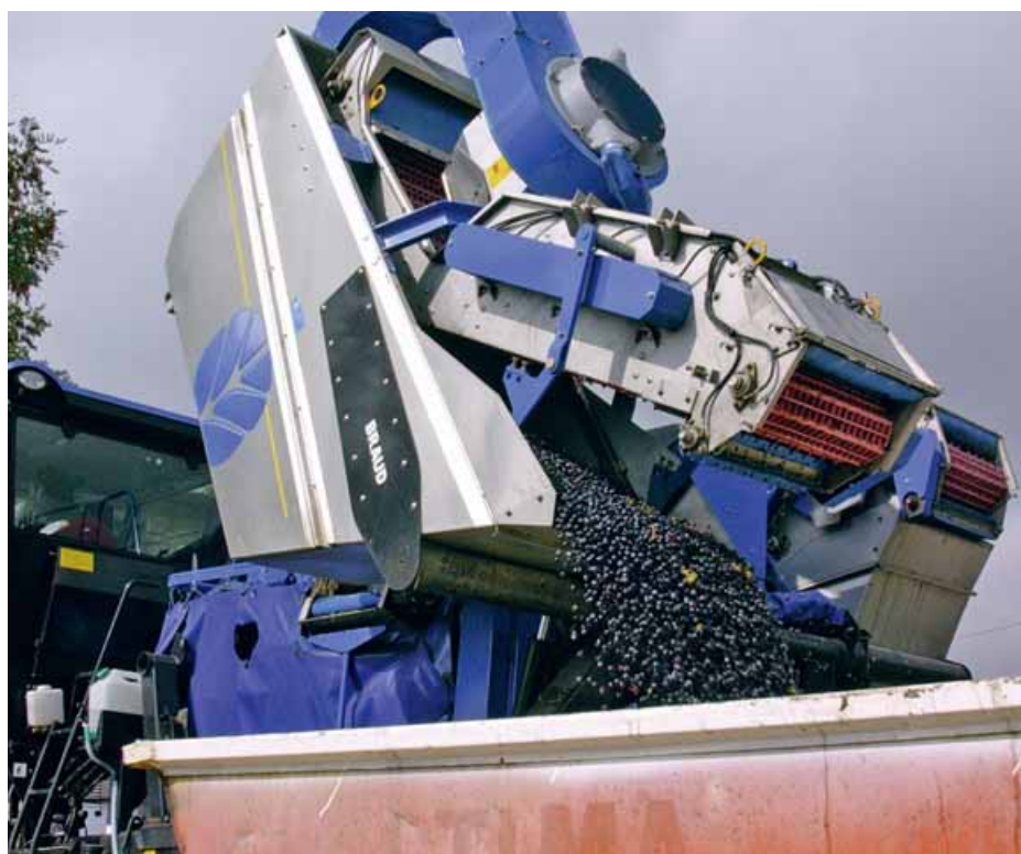
Foto 1 - La complessità della macchina di raccolta non è motivo di preoccupazione né per le competenze di gestione né per gli ingombri o il costo, se tutto ciò serve a separare il prodotto di elevata qualità. I gruppi di pulizia, ormai comuni sulle vasche (benne) delle vendemmiatrici, ne sono la prova evidente
