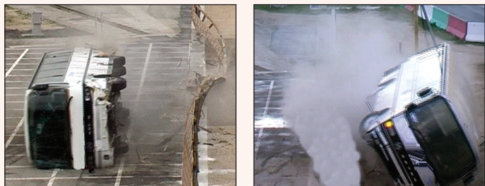
Figure 2 e 3 - Esempi di prove di crash effettuate con esito negativo
