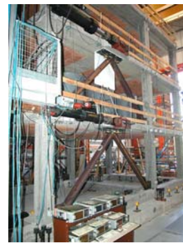
Figura 2. Viste fotografiche delle strutture di acciaio e di cemento armato dotate del sistema a controventi dissipativi, sperimentate nell'ambito del Progetto DISPASS.
