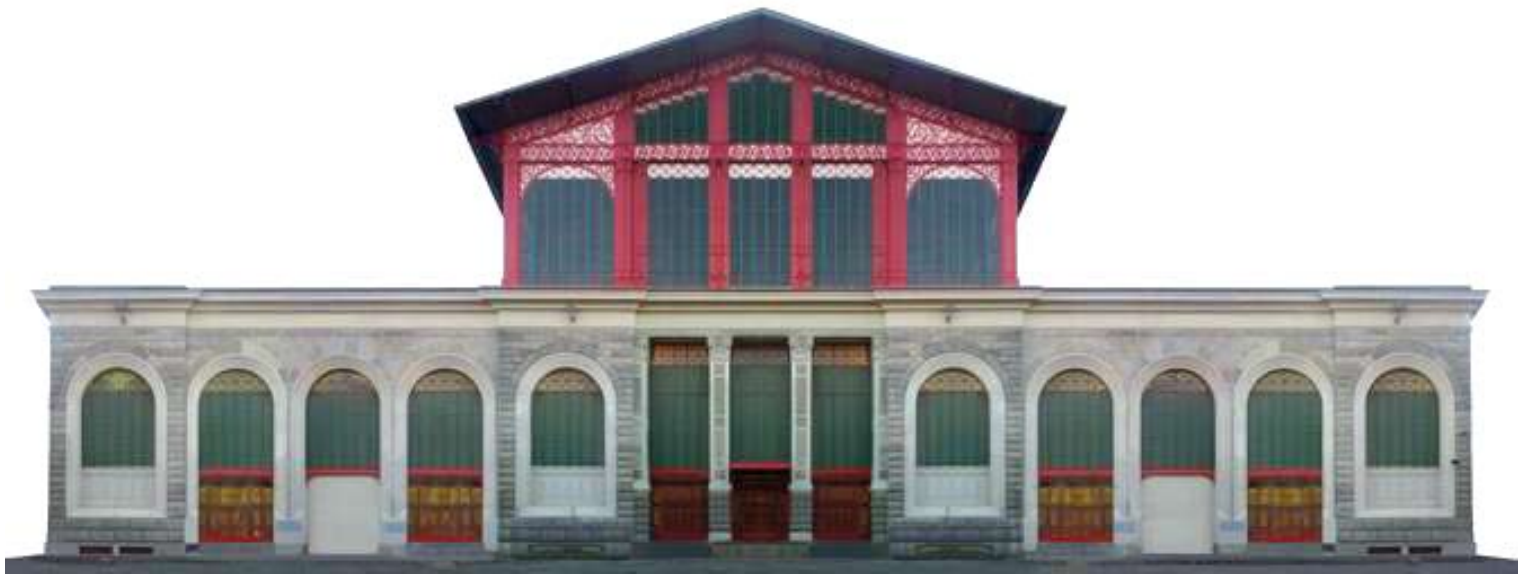
Mercato centrale, fronte principale: in alto, rappresentazione ad acquerello delle cromie rilevate (a.a. 2006/2007, studenti Alessandro Berti e Francesca Capitini); sopra, restituzione in fotopiano dello stesso prospetto
