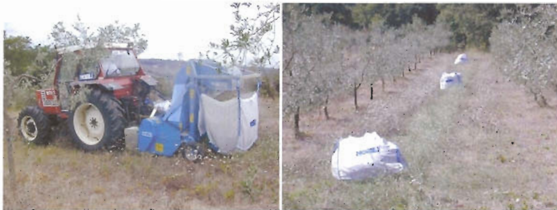
Fig. 6. I residui di potatura possono costituire una notevole fonte energetica. Possono essere raccolti con macchine particolari che confezionano il materiale tritato per poi trasportarlo agli impianti di trasformazione.
