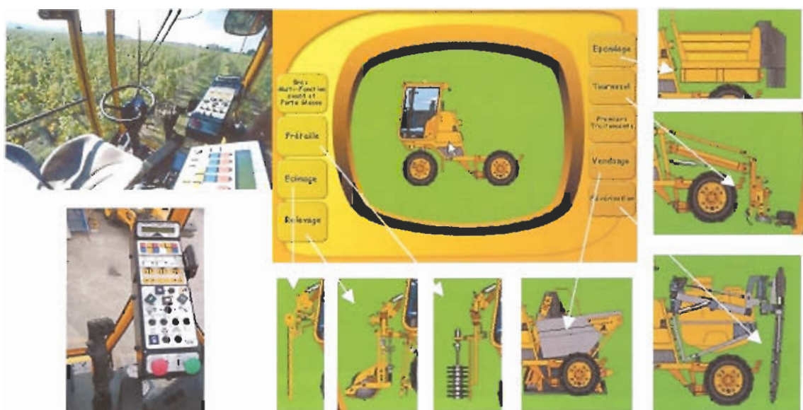
Fig. 4. Il sistema "Smart System" della Pellenc. Gli accoppiamenti portanti, il sistema di prese di potenza e i controlli sono normalizzati ed è possibile effettuare con rapidità i cambi di operatrice. Il computer di bordo per mezzo del protocollo di trasmissione dati normalizzato sul protocollo CAN-BUS può effettuare i controlli.
