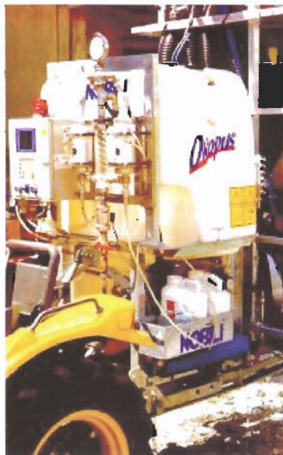
Fig. 7. Il Dosasystem – progettato dal Diaf e realizzato dalla Nobili – consente di variare il prodotto distribuito e la sua concentrazione sulla base di informazioni digitali e del controllo di posizione GPS.
