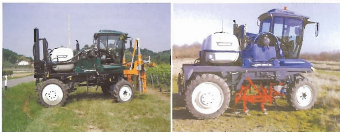
Fig. 3. Il sistema scavallante a carreggiata variabile della New Holland. Gli attrezzi possono essere assemblati anteriormente, posteriormente e centralmente su entrambi i lati. Ogni utensile ha una presa di potenza idraulica e sistemi di controllo della posizione.
