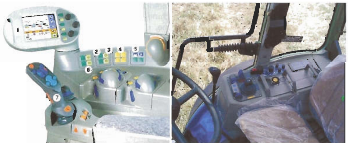
Fig. 2. Per poter controllare separatamente il funzionamento delle molteplici operatrici che operano contemporaneamente i moderni trattori sono dotati di un quadro di comando con impugnature multifunzione e regolazioni elettroniche che controllano un numero sempre maggiore di funzioni.
