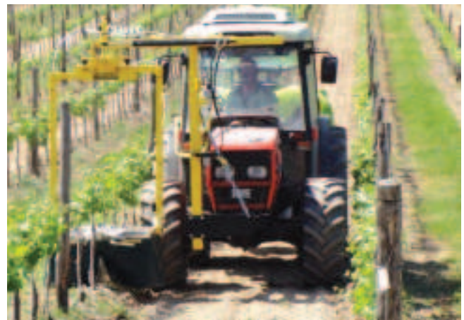
Fig. 25 - Spollonatrice chimica in azione. Fig. 25 - Pinching machine on work.
