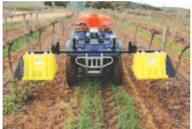
Fig. 23 - Applicazione del sistema Weedseeker in vigneto su Quad 4x4.
