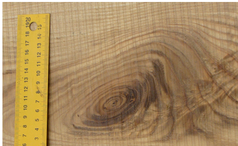
nodo di dimensioni non ammissibili ( d=60\text{mm} , D=85\text{mm} , A=0,48 )
