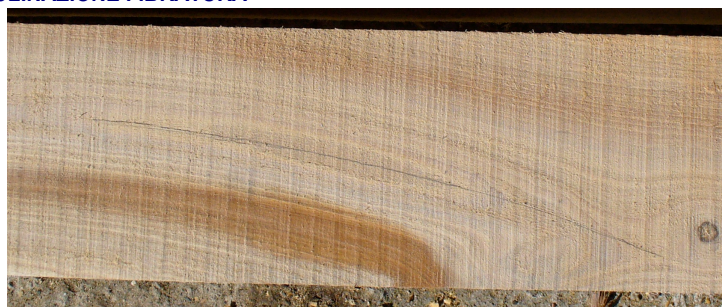
Inclinazione fibratura non ammissibile ( 21,7cm su 100cm, il tratto misurato è inferiore a 1 metro per la forte deviazione locale della fibratura)
