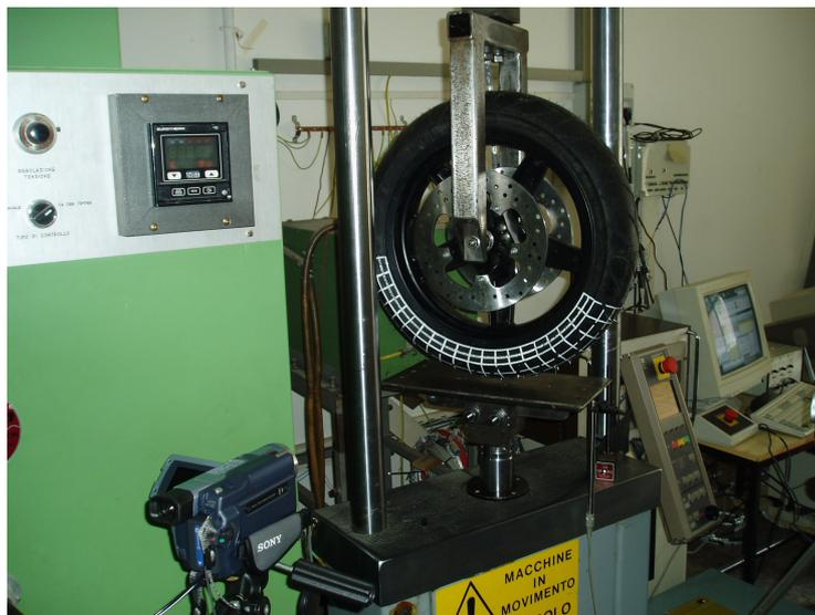
Figura 4 Prova di compressione per il pneumatico anteriore
