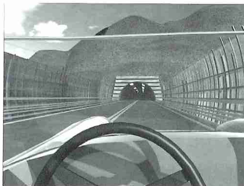
Strada dei marmi: prospetto e vedute prospettiche del viadotto Santa Croce nel primo lotto della Strada dei marmi. I dispositivi di mitigazione acustica sono rivestiti con elementi in legno.
