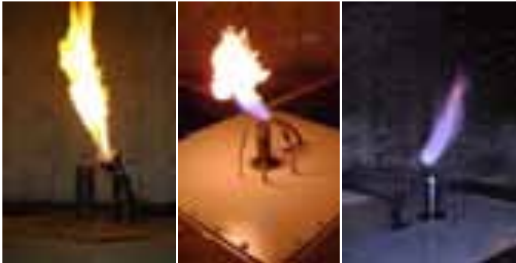
Figura 23: Fiamma di innesco prodotta dalle tre tipologie di pilota sviluppate
