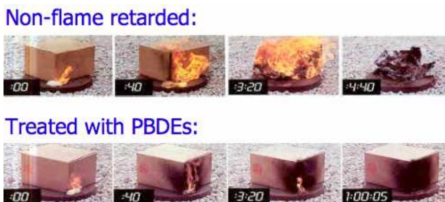
Figura 1.1.1 - Comportamento di sostanze non additate e additate con ritardanti di fiamma durante la combustione
