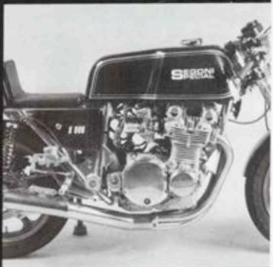
Segoni special con motore Kawasaki Z1 900. Di queste fu realizzato una piccola serie.
