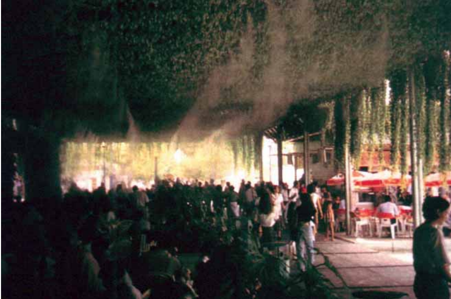
Fig. 2.2 Strategia di raffrescamento di uno spazio esterno basato sull'uso combinato di vegetazione e acqua: pergola "raffrescata" realizzata in occasione dell'Expo di Siviglia del 1992.
