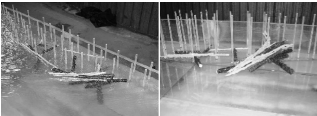
Figura 8. a) Accumulo di detriti sul modello della vegetazione riparia durante l'esecuzione delle prove. b) Accumulo dopo la diminuzione dei livelli idrici.
