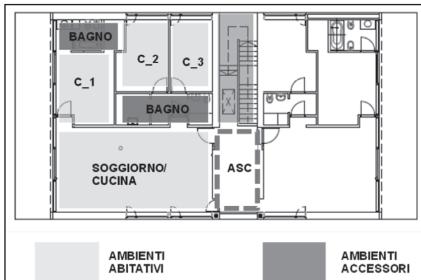
Fig. 5 – Pianta unità immobiliare in analisi
