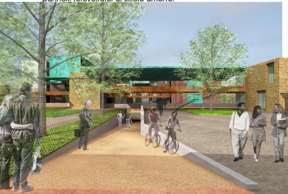
206 Una grande copertura continua attraversa tutti i corpi edificati 207 raccordandoli con un nastro che ripete l'andamento principale delle percorsi attorno alla piazza pubblica. Si tratta sia di una protezione del ballatoio che di una macchina energetica, fatta di pannelli fotovoltaici di silicio amorfo.
