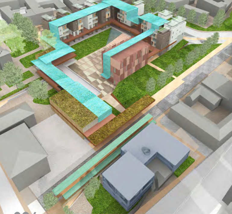
206 Una grande copertura continua attraversa tutti i corpi edificati 207 raccordandoli con un nastro che ripete l'andamento principale delle percorsi attorno alla piazza pubblica. Si tratta sia di una protezione del ballatoio che di una macchina energetica, fatta di pannelli fotovoltaici di silicio amorfo.
