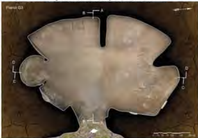
Abitazione a capanna con camino e cucina Pianta subcircolare, parete di fondo con nicchia deposito. Cucina sulla parete destra a destra dell'ingresso. Finestra rettangolare. Apertura posteriore con la contigua unità 5. Camino sulla sinistra. Nicchia deposito di fronte.
