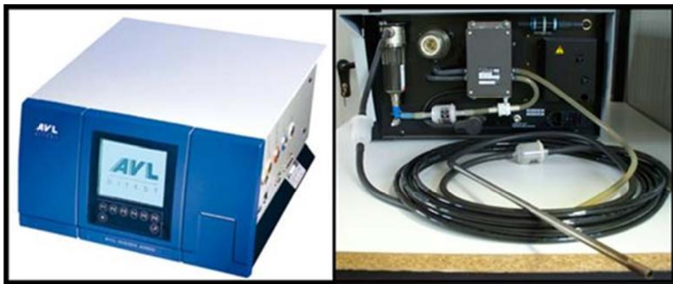
Figura 2.15 - Hardware e software AVL DIGAS 4000 NOX (foto a sinistra); allacciamento della sonda di campionamento (foto a destra)
