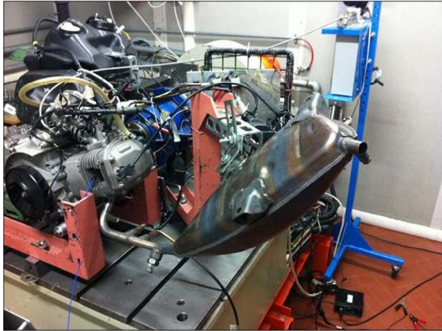
Figura 2.38 - Motore 125cc Piaggio all'interno della sala prova ed allestimento per la misura diretta della potenza e della coppia all'albero motore, ripetuta sia nella prima che nella seconda versione di sviluppo del motore
