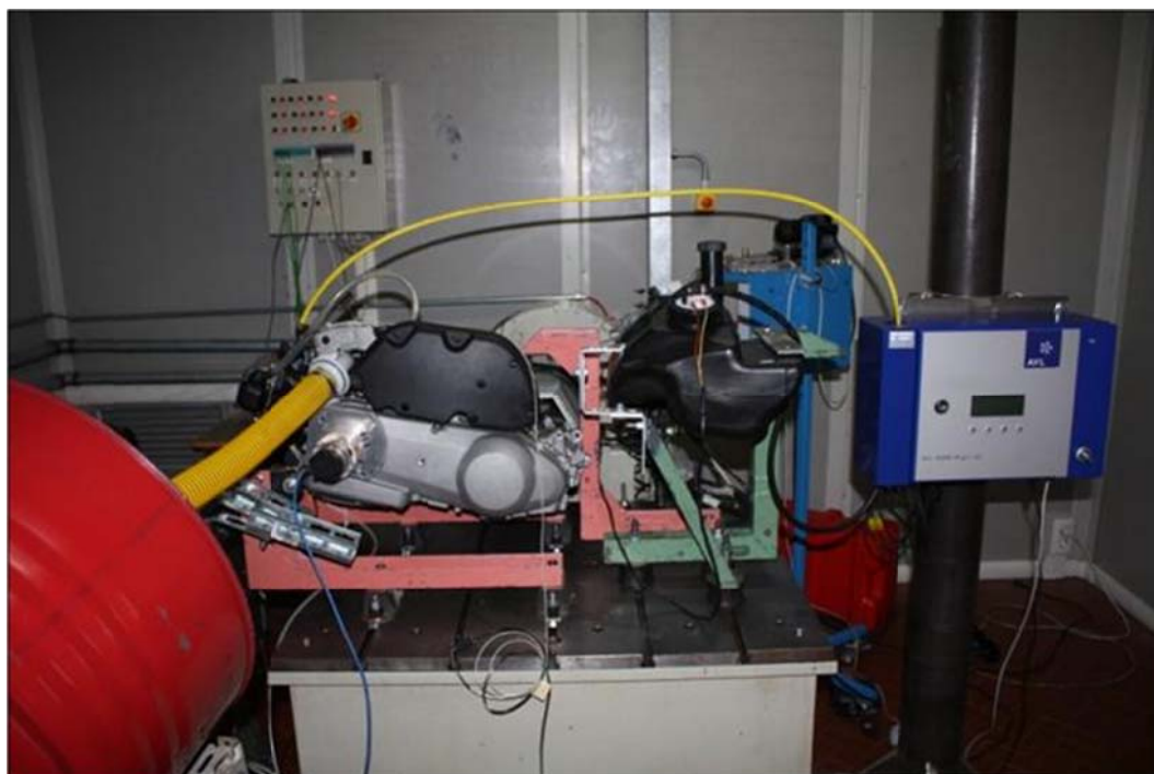
Figura 2.1 – Motore 125cc Piaggio all'interno della sala prova ed allestimento di tutta la strumentazione
