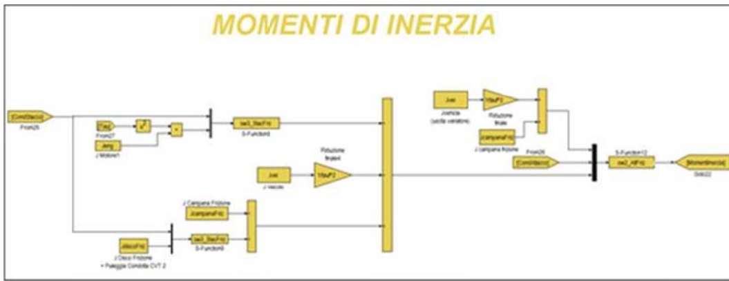
Figura 4.6 - Blocco del modello veicolo per il calcolo del momento di inerzia equivalente totale
