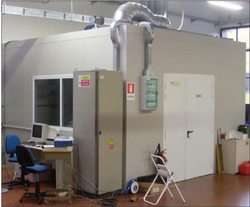
Figura A 3 - Cella insonorizzata ad alto ricambio d'aria
