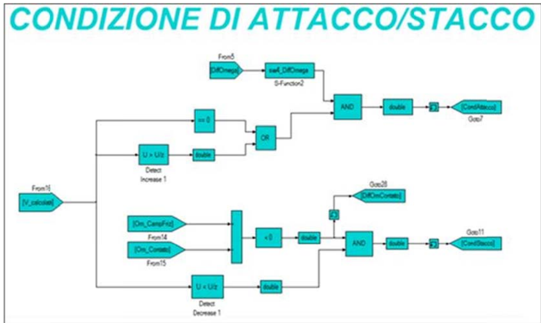
Figura 4.14 - Blocco del modello veicolo atto a determinare le condizioni di attacco e stacco frizione
